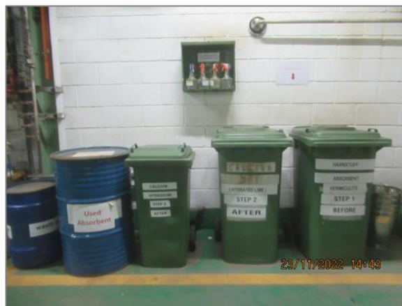
ภาพถ่ายที่ 2.2.2-27 ถังเก็บสารดูดซับ กรณีสารรั่วไหล
