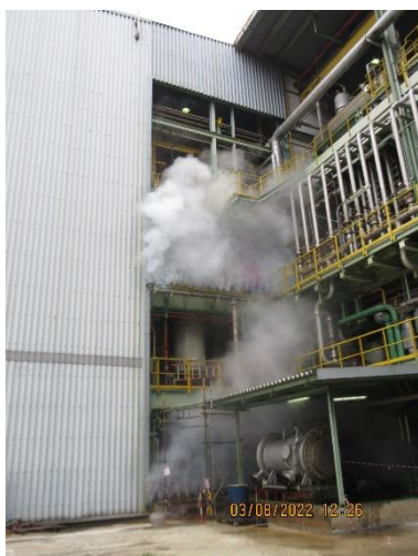
ภาพถ่ายที่ 2.2.2-62 การทดสอบม่านน้ำยา Steam-Ammonia
