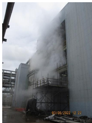
ภาพถ่ายที่ 2.2.2-62 การทดสอบม่านน้ำยา Steam-Ammonia
