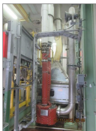
ภาพถ่ายที่ 2.2.2-31 อุปกรณ์ครอบเครื่องจักรที่มีเสียงดัง
